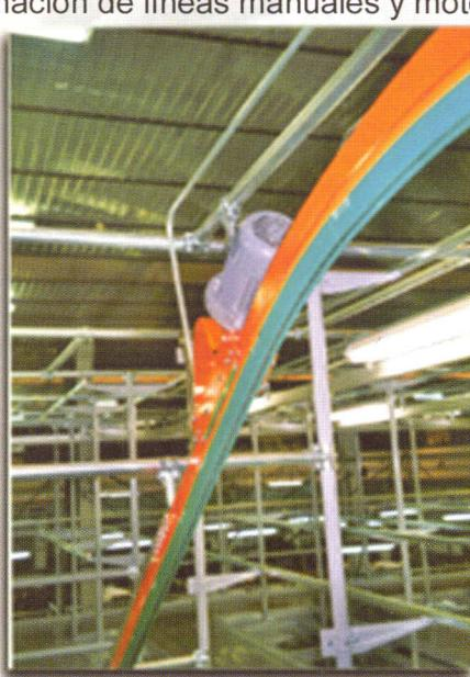
Las líneas pueden trabajar de manera reversible y en utilizando trenes de trolley, a saber, conjuntos de trolley acoplamiento.
