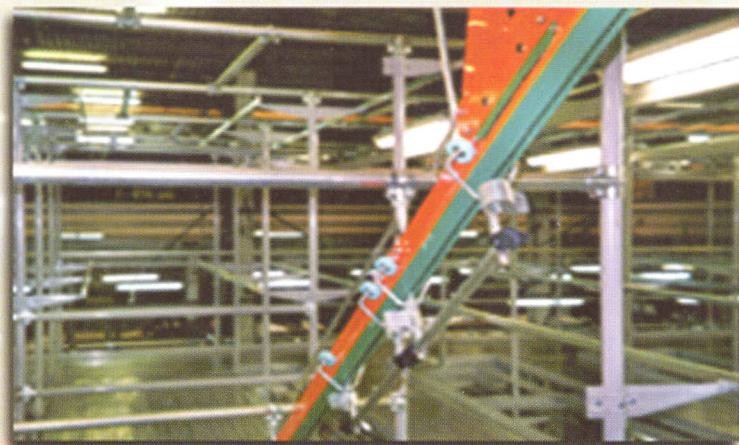
Pour préparer les commandes on peut utiliser un système de picking rapide grâce au système de tri automatique dans lequel les vêtements sont classés par commandes ou par destinations.
